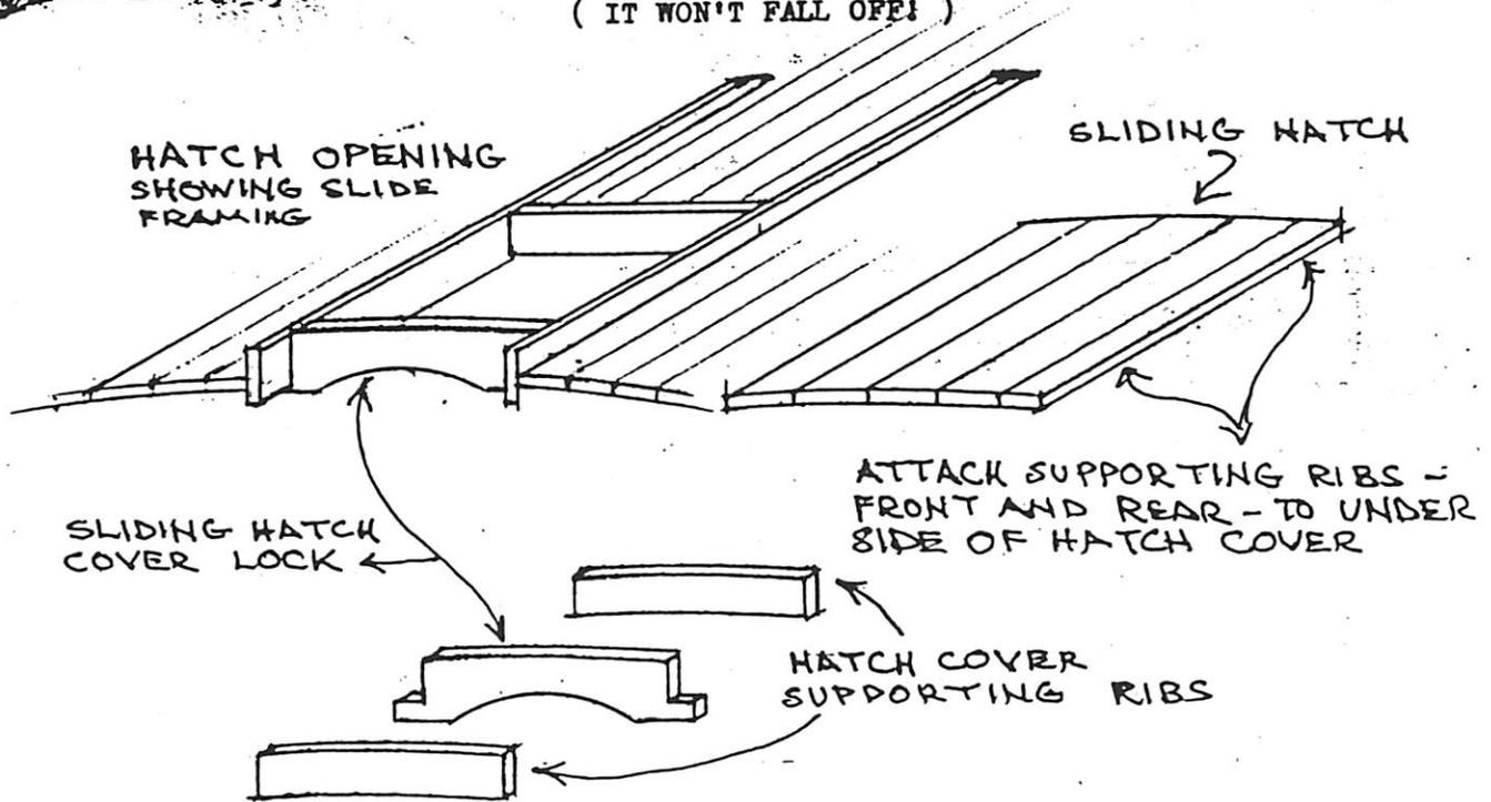
NOTE: GLUE FASTEN THE SLIDING HATCH COVER
